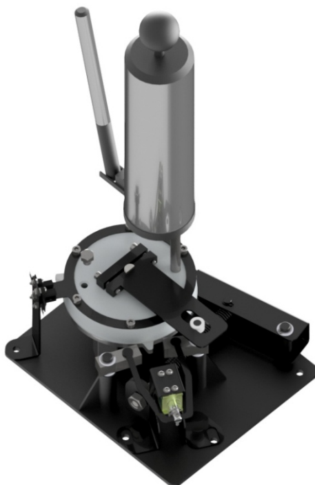
Рисунок 27 – Доливка демпферной жидкости
