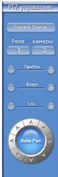
Реле вкл/выкл: управление внутренним реле PTZ камер (**реле 2**) или декодеров (**реле 1**); позволяет включать подсветку и контролировать ворота доступа.
