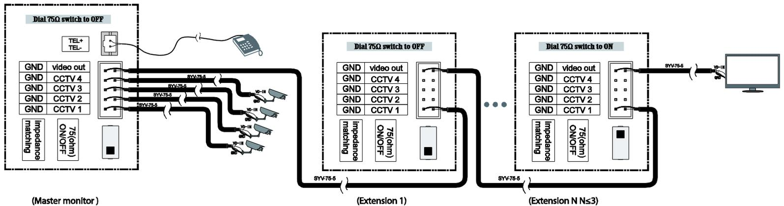
Только мастер может подключаться к видеокерам, и дополнительные мониторы получают видео от мастера. Дополнительные мониторы могут контролировать видеокерамы после отправки просьбы к мастеру. Только один монитор может контролировать видеокерамы одновременно.
