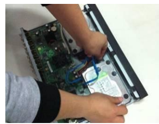
Падключыце SATA кабель і кабель харчавання на ніжняй і задняй частцы корпуса і зачыніце корпус верхняй вэчкам.
