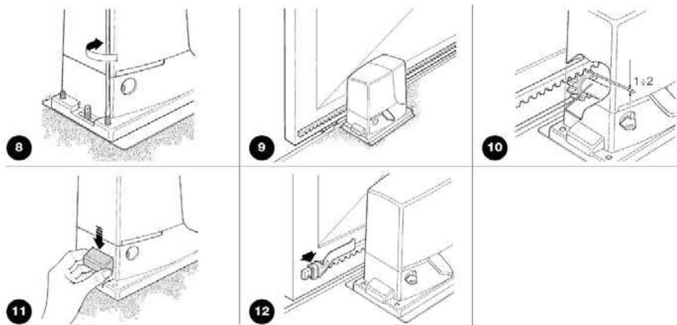
установлена, как только электропривод был закреплен, использовать регулирующие винты, как показано на Рис. 8, чтобы установить шестерню ROBUS на правильной высоте, оставляя 1÷2 мм зазор от рейки. Иначе, монтажник должен выполнить следующие процедуры, чтобы закрепить рейку.
