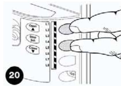
Подключенные устройства могут быть распознаны в любое время, даже после установки, если другие устройства были подключены.
