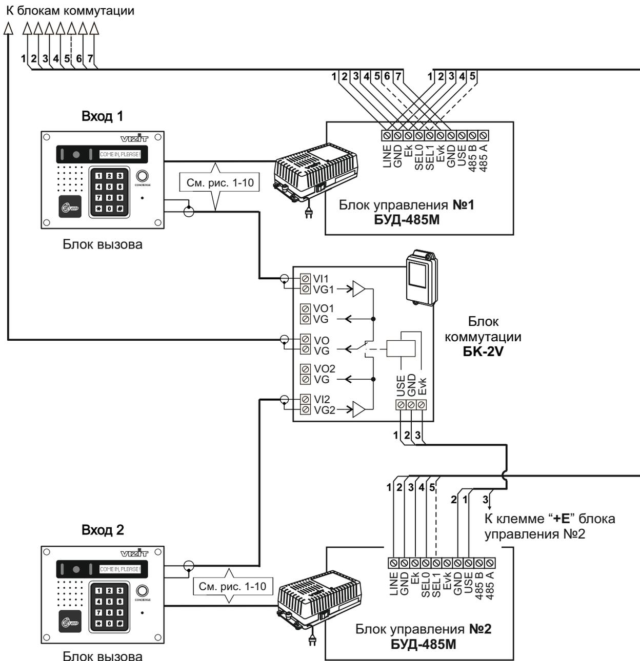
Рисунок 22 - Схема соединений двух блоков управления БУД-485М в составе многоквартирного видеодомофона
