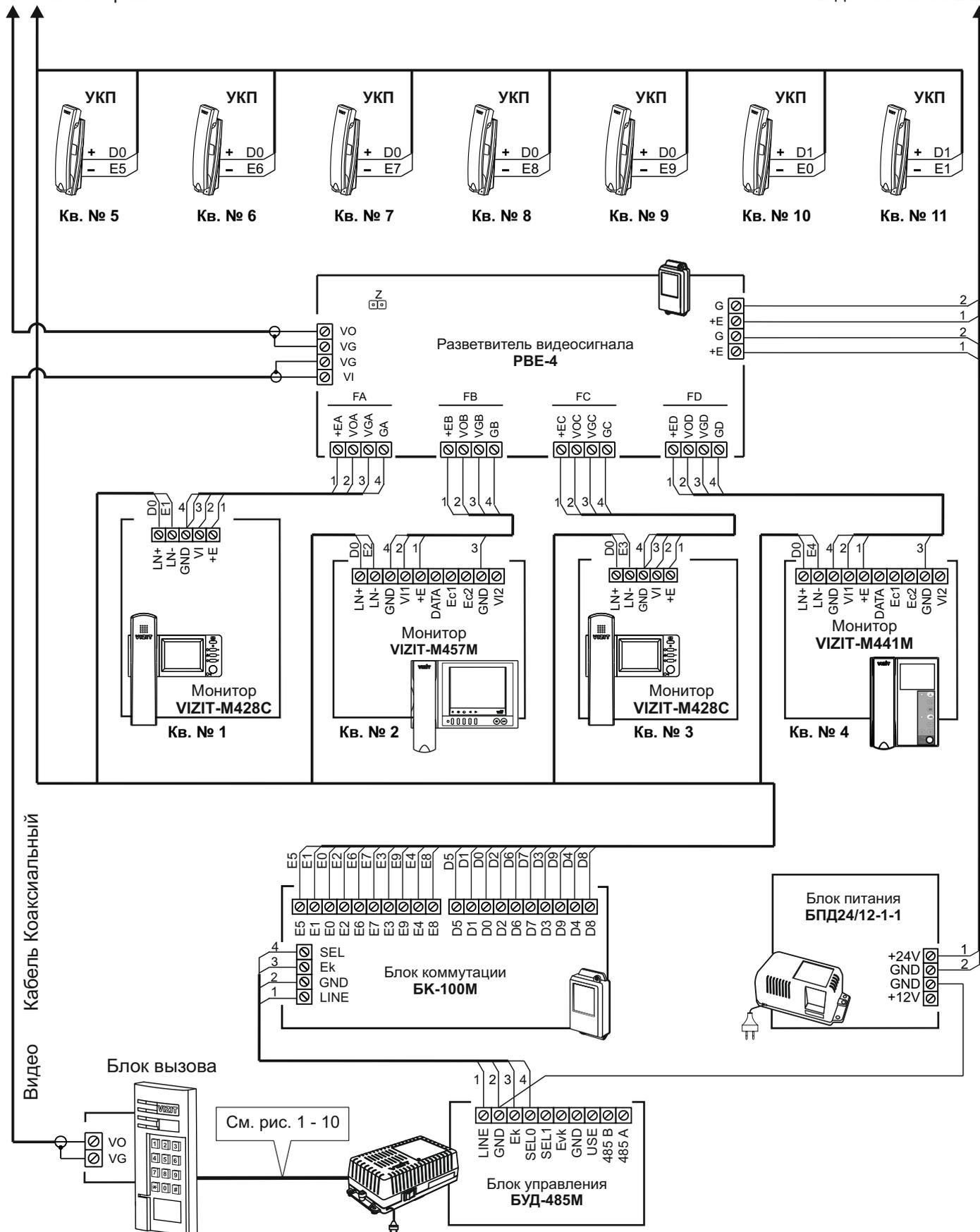
**Примечание.** Рекомендации по расчёту допустимого количества мониторов, подключаемых к одному блоку питания **БПД24/12-1-1** приведены в инструкции по эксплуатации разветвителя видеосигнала **РВЕ-4**.
