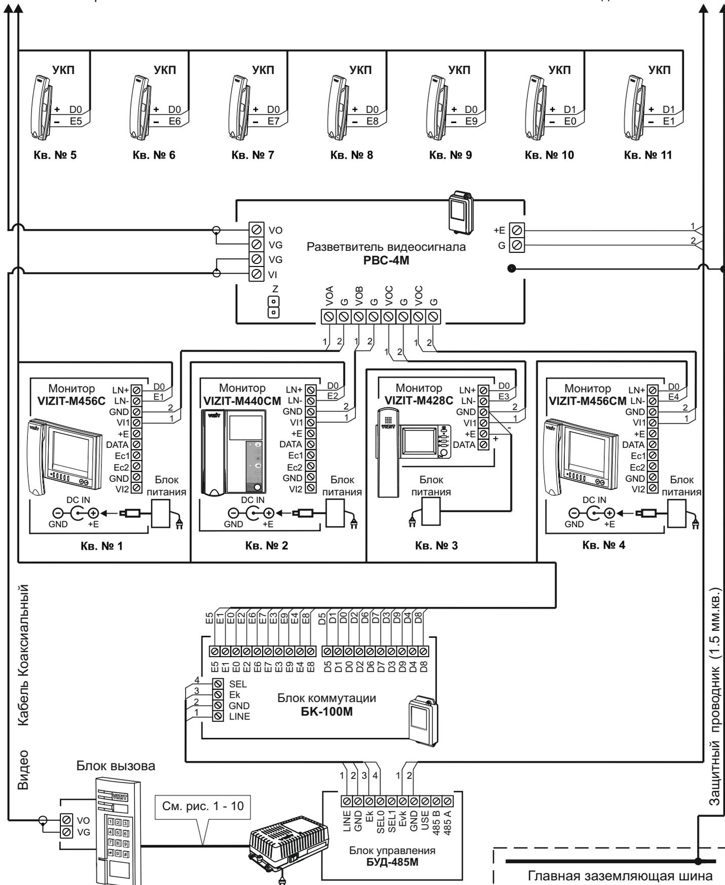
Рисунок 19 - Схема соединений блока управления **БУД-485М** с блоком коммутации **БК-100М**, разветвителем видеосигнала **PBC-4M** и мониторами **VIZIT** в составе многоквартирного видеодомофона до 100 абонентов
