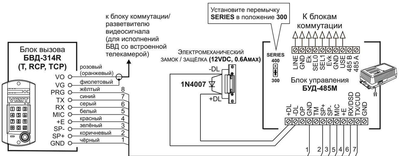
Если электромеханический замок / защёлка не содержат встроенный защитный диод, то между клеммами замка / защёлки следует установить диод, как показано на схеме
