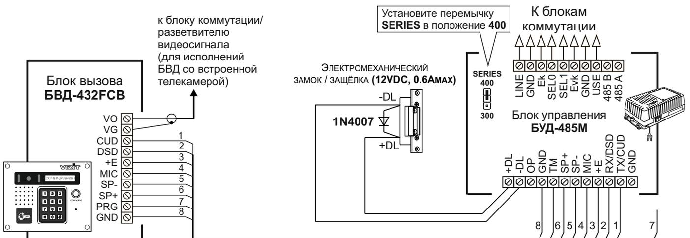
**Примечание.** Подключите провод PRG к клемме GND блока управления при записи МАСТЕР-ключа №1 блока вызова. Отключите провод после окончания записи МАСТЕР-ключа.
