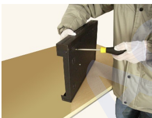
④ затяните шурупы диска
