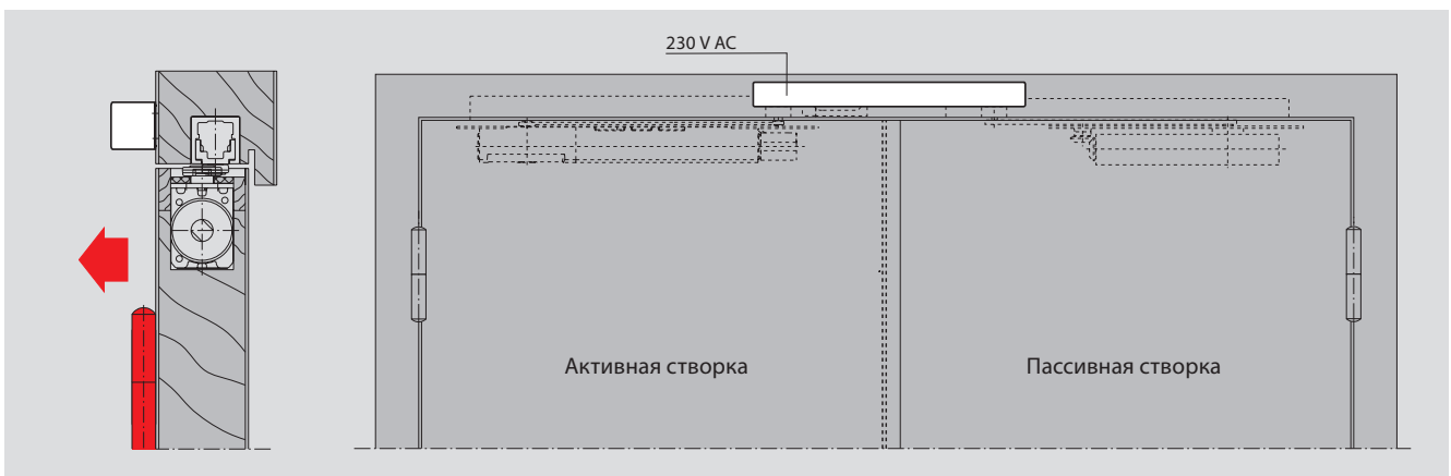
Центральный узел дымовой сигнализации RMZ со стороны петель вместе с ITS 96 FL GSR Пример: дверь DIN-L, дверь DIN-R в зеркальном отражении.
