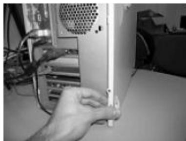
Рис. 3.1—1. Демонтаж крышки корпуса системного блока
