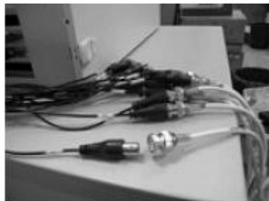
Рис. 3.1—5. Подключение видеокамер к интерфейсному кабелю
