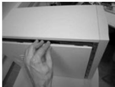
Рис. 3.1—3. Установка крышки корпуса системного блока
