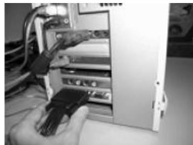
Рис. 3.1—4. Подключение интерфейсного кабеля
