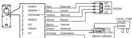
Схема подключения с электромагнитным замком
