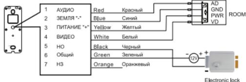
Схема подключения с электромеханическим замком
