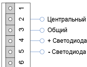
рис. 16. Схема подключения считывателей типа «1-Wire» к клеммам XP2 и/или XP3
