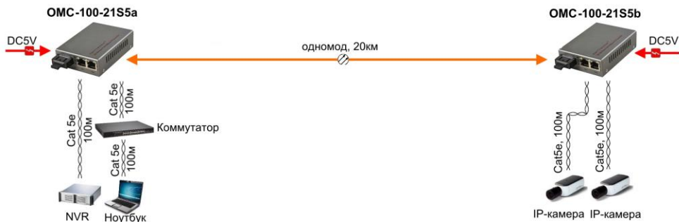
Рис. 7 Схема подключения медиаконвертеров OMC-100-21S5a (OMC-100-21S5b)
