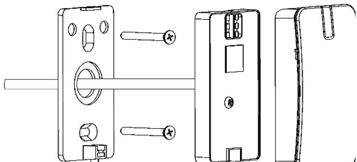
Для подключения рекомендуется кабель UTP с сечением каждого провода не менее 0,22 мм<sup>2</sup>. Сигналы DATA 0 и DATA 1 рекомендуется передавать в отдельных повитых парах с замыканием второго повивающего проводника на GND контроллера СКУД.
