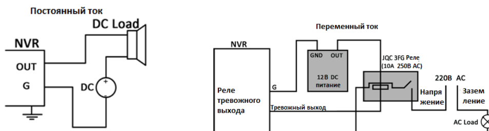
Рисунок 2.5 Подключение тревожного выхода
