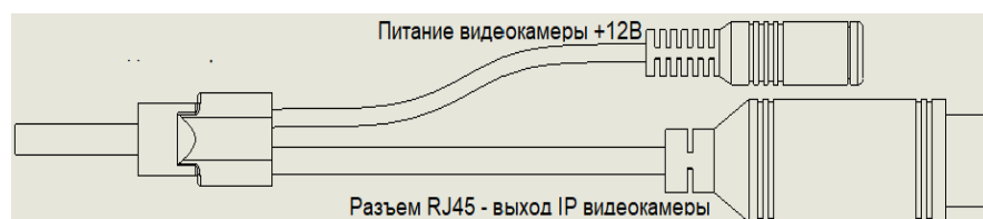
Рис.2 Назначение разъемов видеокамеры EVM2-IPx корпус KP23 п/п 1...8.
