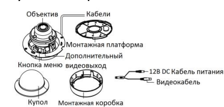
Рисунок 1-13 Купольная камера III типа
