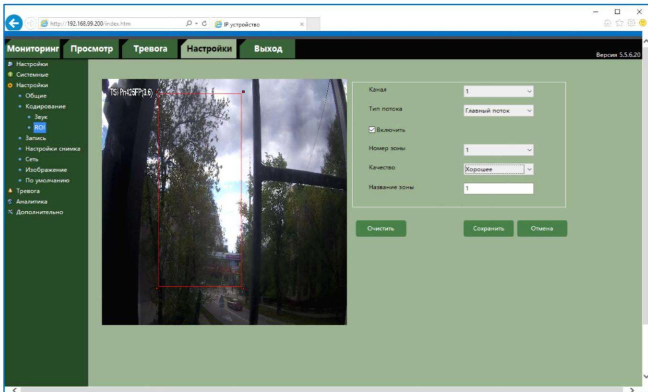
Функция ROI позволяет оптимальным образом сочетать небольшой размер трафика от камеры и высокое качество записи наиболее важных областей изображения.
