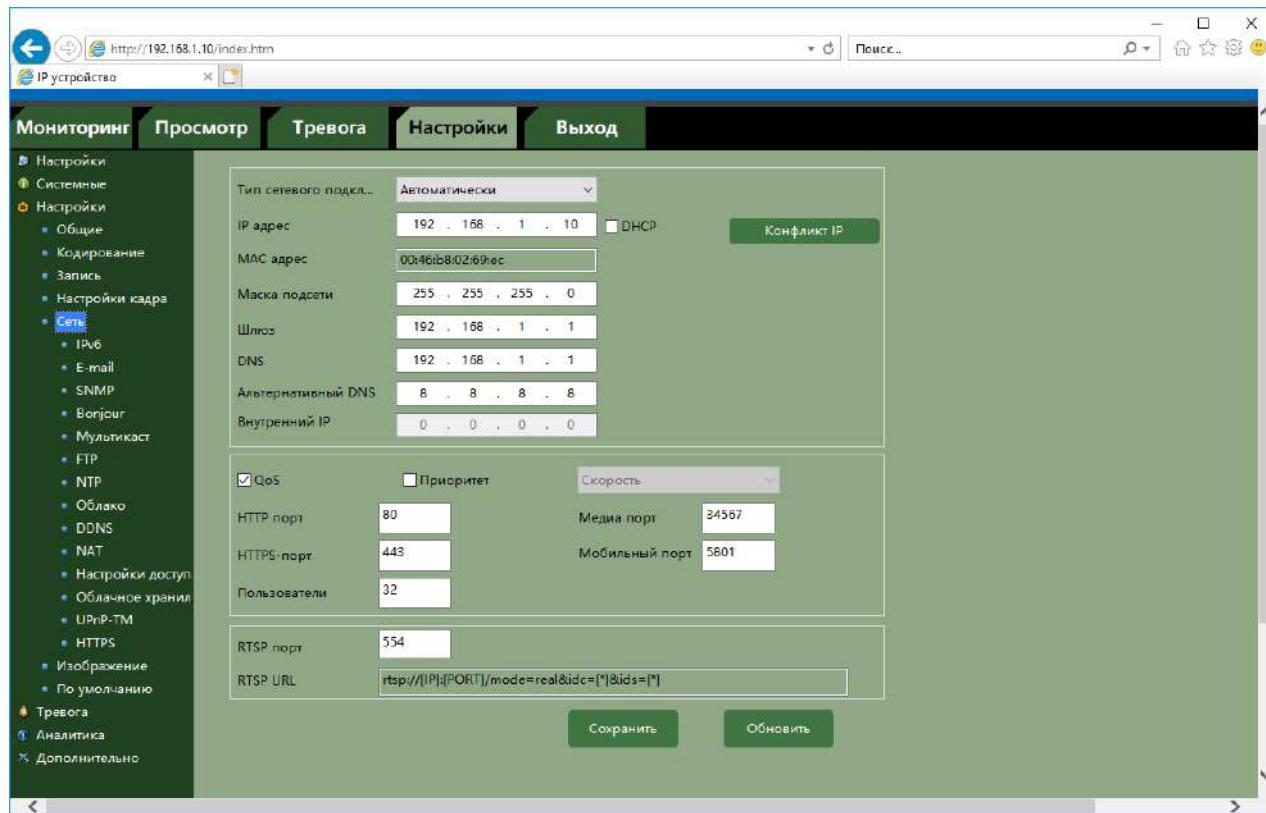
**Тип интерфейса** – скорость подключения камеры по Ethernet. 10/100 Мбит/с, дуплекс/полудуплекс.
