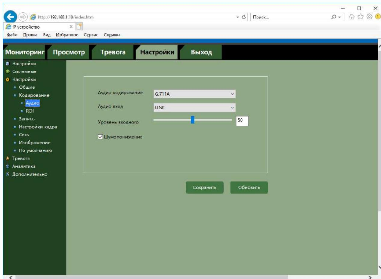
В меню **Аудио кодирование** выбирается тип кодека (пока доступен только G.711a).
