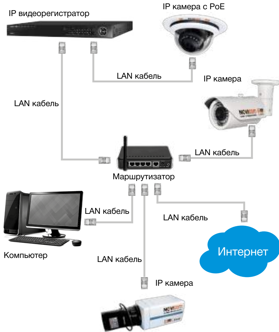
Рисунок 3.19 Подключение IP видеорегистратора с PoE.
