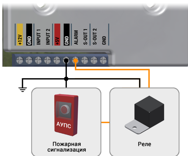
Рисунок 21 - Подключение АУПС к турникету.
