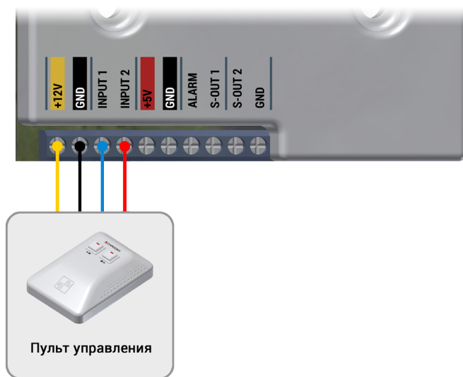
Рисунок 18 - Подключение ПДУ к турникету.
