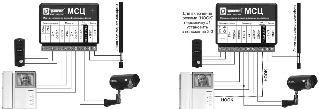
При подключении по правой схеме, не забудьте перевести перемычку J1 в положение 2-3, при этом назначение клеммы 10 переключится из GND во вход сигнала HOOK. Общий провод сигнального кабеля подъездного видео нужно подключать к любой другой клемме GND (2 или 6) в такой конфигурации. Данная схема подключения действительна только для модулей сопряжения МСЦ версии 1е и выше.
