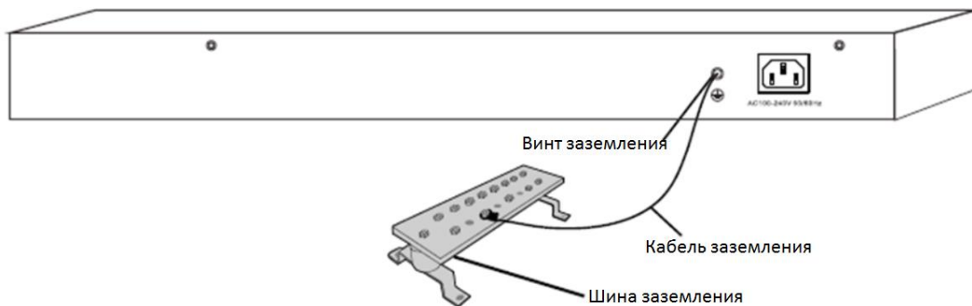
Рисунок 2.5 Подключение шины заземления
