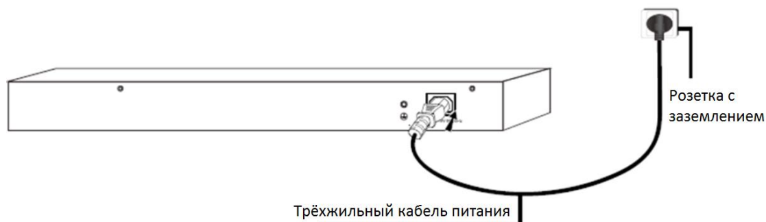
Рисунок 2.8 Заземление с использованием трёхжильного кабеля питания
