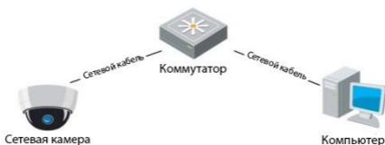
Рисунок 3-2 Соединение через коммутатор или роутер
