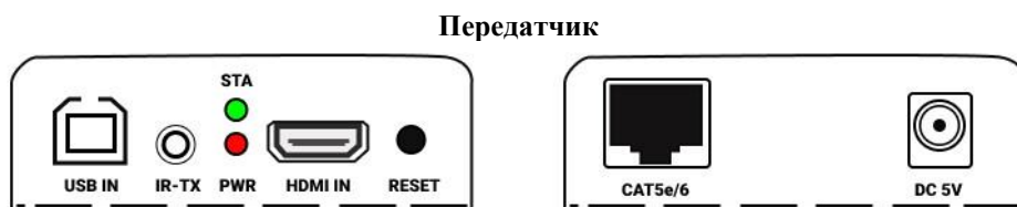
Рис. 1. Расположение и назначение элементов коммутации. Передатчик.
