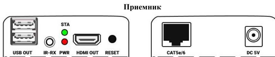
Рис. 2. Расположение и назначение элементов коммутации. Приемник.
