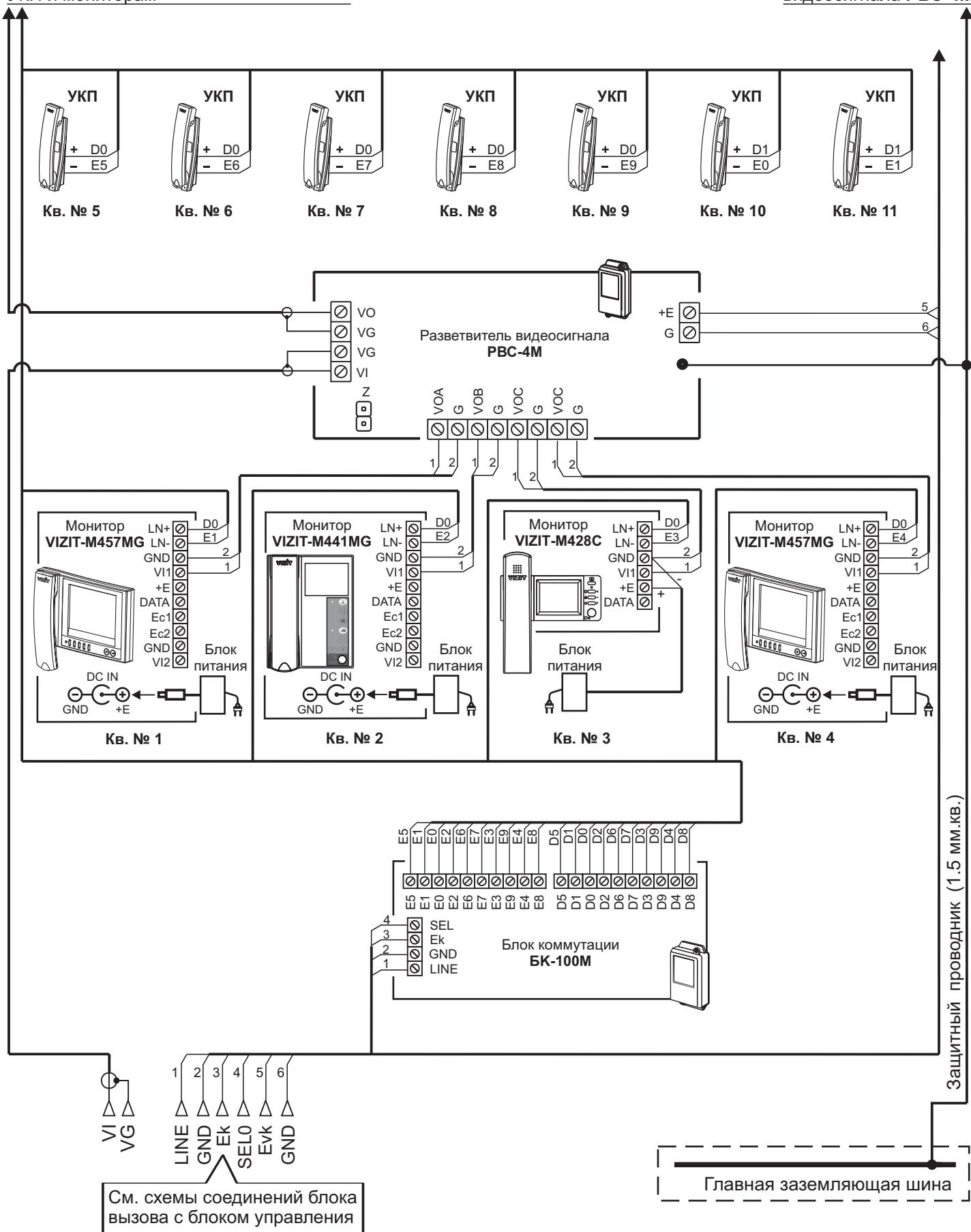
Схема соединений блока управления с блоком коммутации БК-100М, разветвителем видеосигнала РВС-4М и мониторами VIZIT в составе многоквартирного видеодомофона до 100 абонентов
