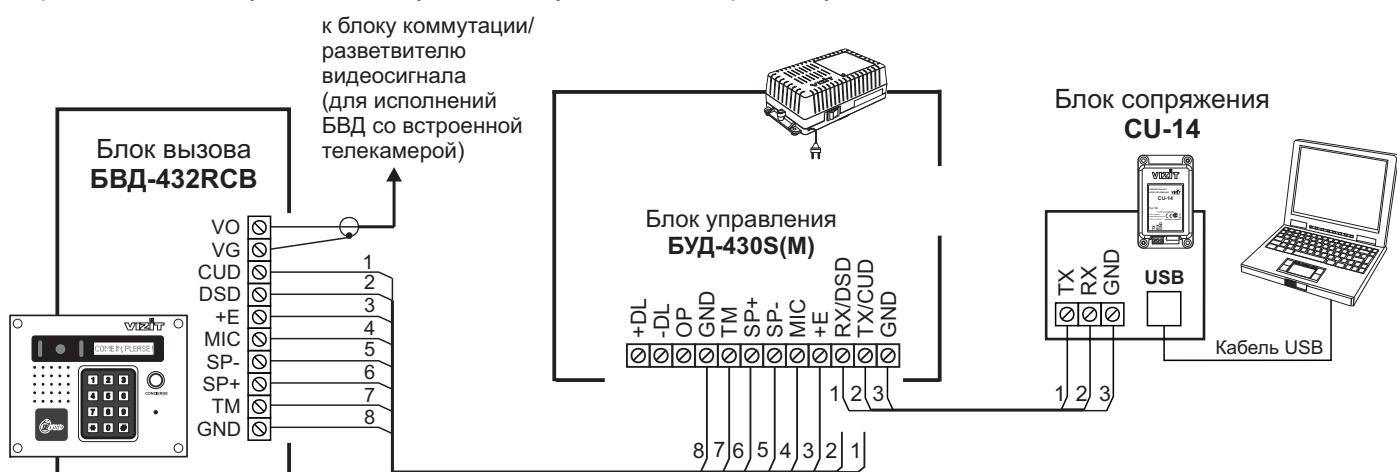
Схема соединений блока управления БУД-430S(M) с блоком сопряжения CU-14 и компьютером
