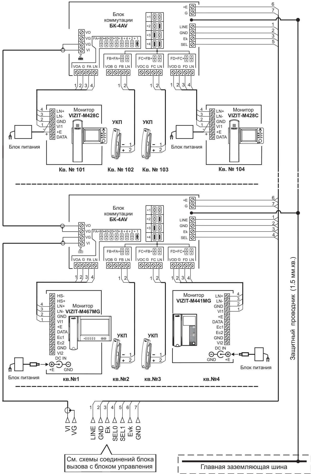
Схема соединений блока управления с блоками коммутации BK-4AV и мониторами VIZIT в составе многоквартирного видеодомофона до 200 абонентов
