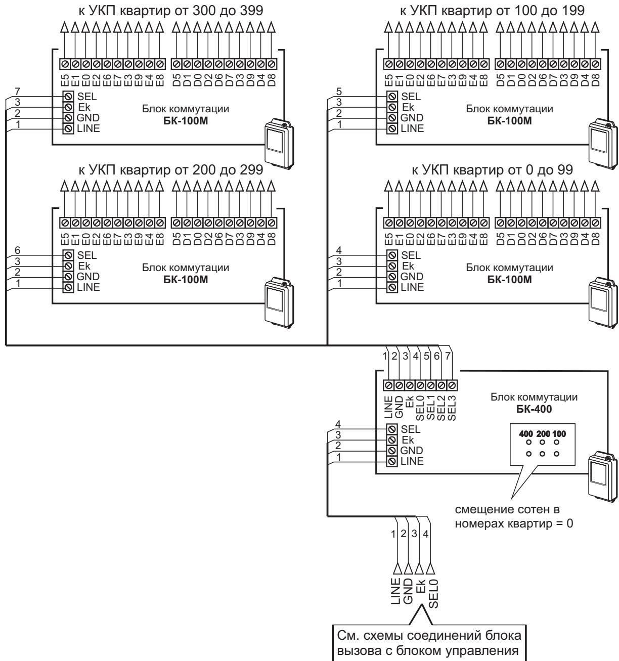
Схема соединений блока управления с блоком коммутации БК-400
