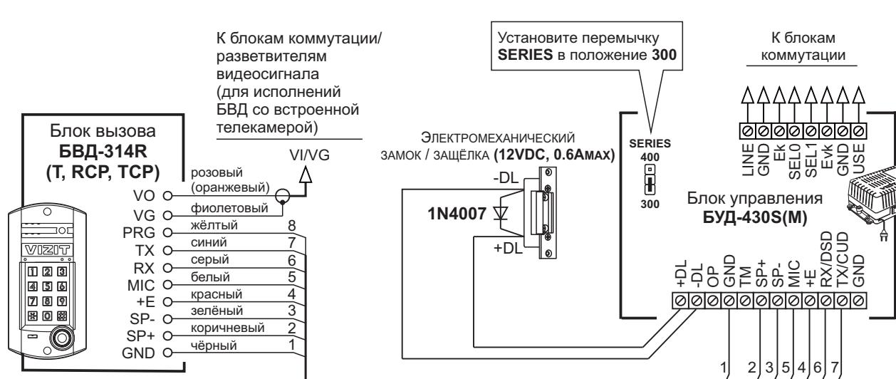
Если электромеханический замок / защёлка не содержит встроенный защитный диод, то между клеммами замка / защёлки следует установить диод, как показано на схеме
