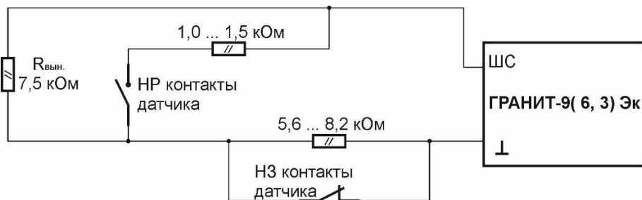
Рис.6. Схема включения технологических датчиков в ШСТ.
