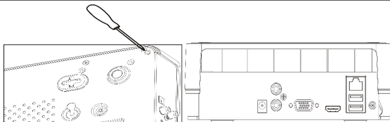
Рисунок 2.1 Демонтаж крышки регистратора
