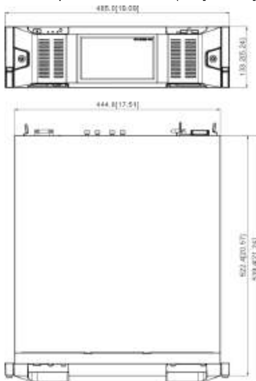
Рис. 2-15 Габариты без дисплея (мм [дюймы])
