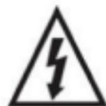
Данное устройство при определенных условиях может иметь опасно высокое напряжение внутри корпуса, которое может вызывать поражение электрическим током.
