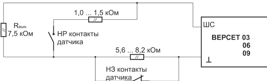
Рис.6. Схема включения технологических датчиков в ШСТ.
