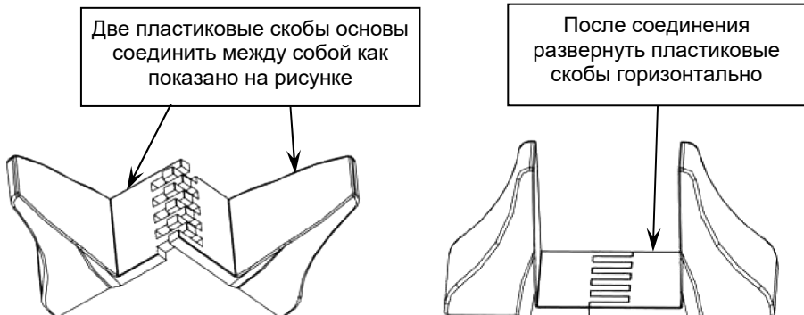
Рисунок 3 - Сборка пластиковых основ для вертикальной установки изделия.
