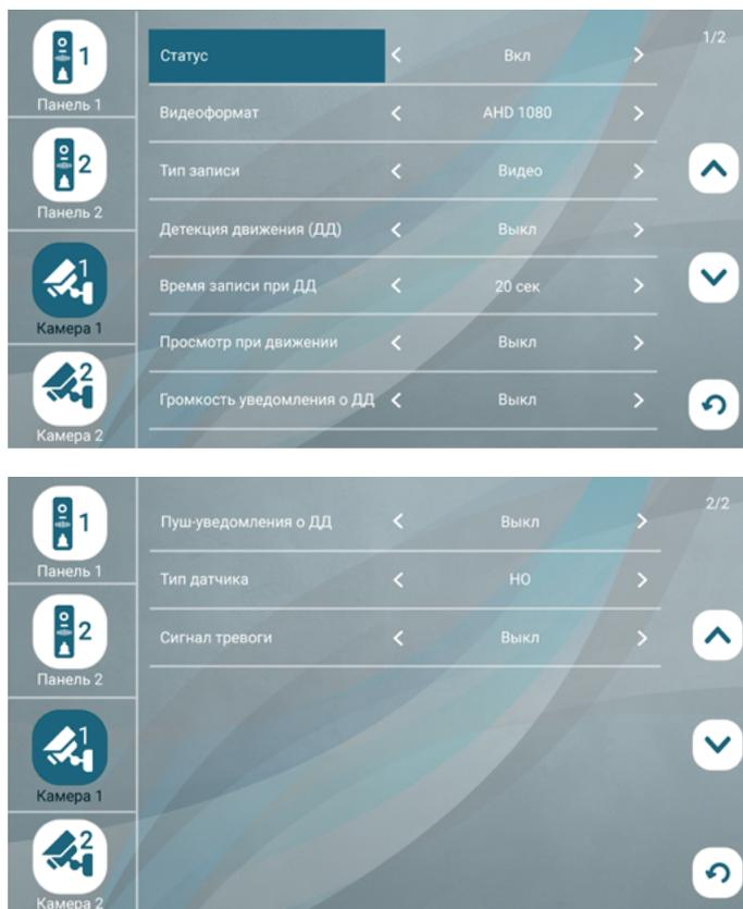
Установите значение **Вкл** в строке **Статус** для каждой подключенной камеры. Если к вашему монитору не подключены дополнительные камеры, выберите значение **Выкл** в строке **Статус** на вкладках **Камера 1** и **Камера 2**. В этом случае монитор будет пропускать пустые экраны этих каналов при переключении каналов в режиме просмотра (⇒ раздел 6.1 Режим просмотра на стр. 20), а иконка этого канала на главном экране станет блеклой.
