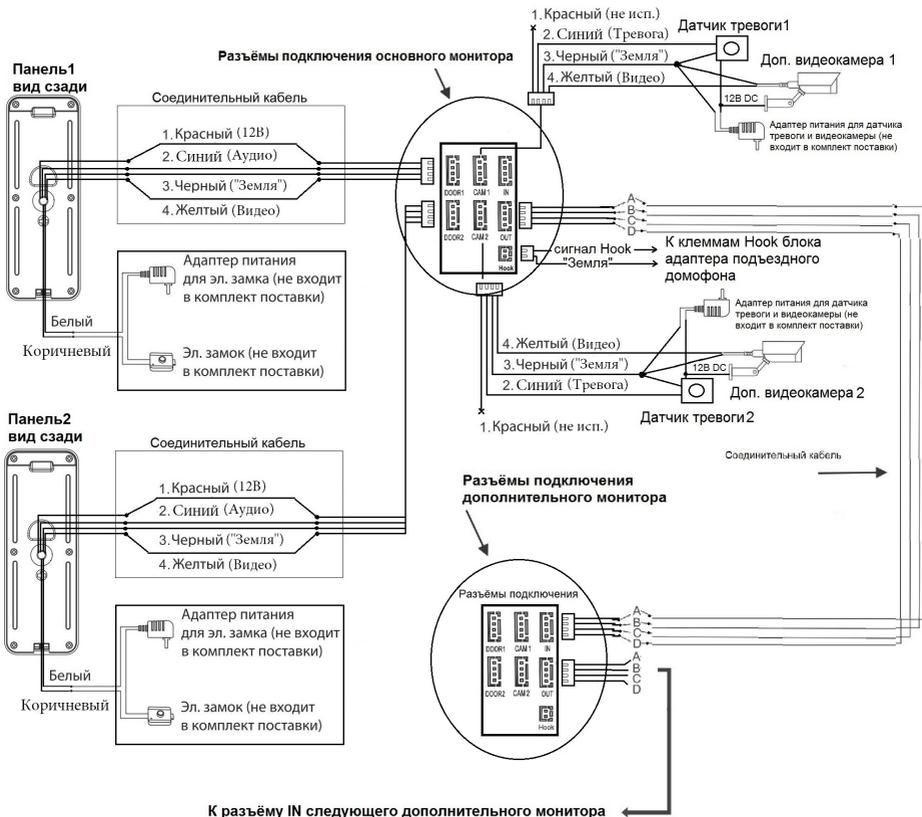
В экранном меню основного монитора должен быть включен режим «Основной», а в дополнительных - режим «Дополнительный» (подробно на стр. 26 данной инструкции).
