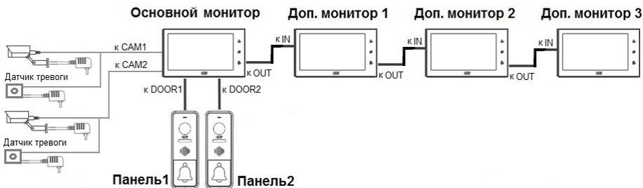
Вызывные панели подключаются только к основному монитору.
