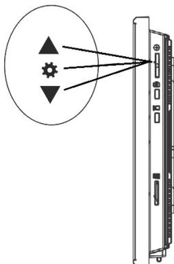
Кнопка-колесико, расположенная на боковой части монитора CTV-M4705AHD, имеет следующие функции:
