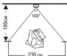
Угол обзора по горизонтали составляет  $100^\circ$ , по вертикали -  $50^\circ$ , что позволяет обеспечить зону наблюдения шириной 238 см и высотой 93 см на расстоянии 100 см от панели.
