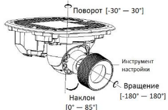
Рисунок 1-25 Настройка угла наблюдения камеры
