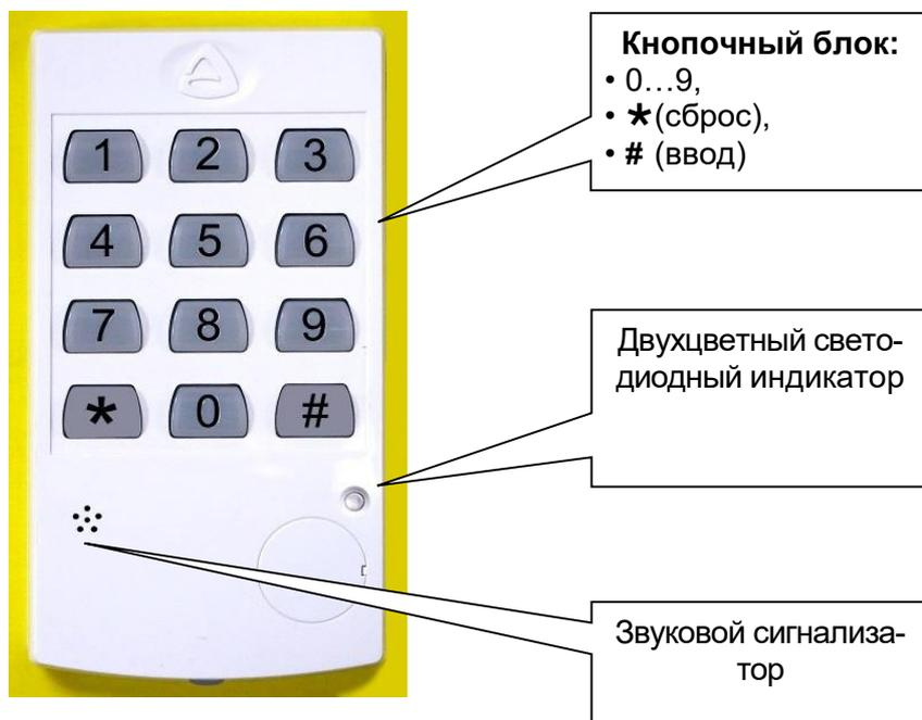
Для удаленного управления прибором панель принимает введенную пользователем комбинацию цифр - код пользователя – четыре цифры. Затем нажимается кнопка «#» и кнопка с номером команды:
