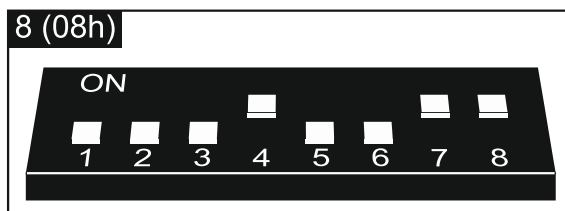
Рис. 14. Способ установки DIP-переключателей в контроллере ACU-100.
