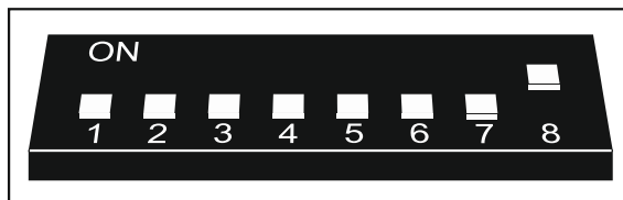
Рис. 13. Способ установки DIP-переключателей в контроллере ACU-120 / ACU-270.
