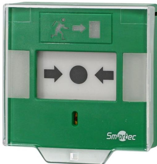
Устройство разблокировки дверей ST-ER106DLS-GN рекомендуется к использованию для разблокировки электрически управляемых замков в экстренных случаях с внутренней стороны на выход, например, при эвакуации людей. Восстановляемая кнопка активации позволяет быстро и без дополнительных расходов (замена при использовании стеклянных вставок) восстановить нормальный режим эксплуатации дверей после осуществления эвакуации.
