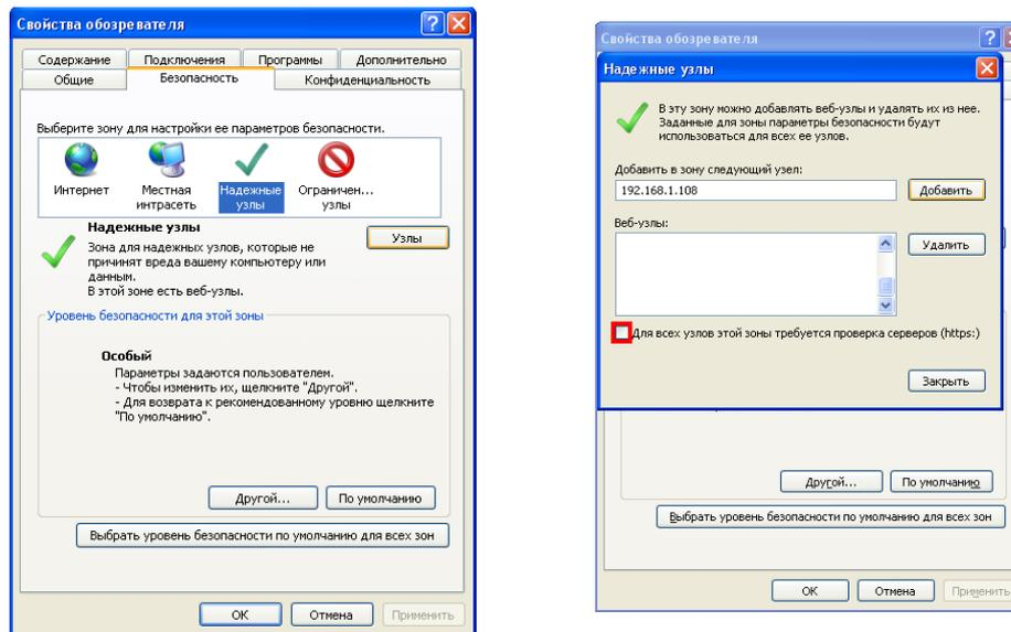
Откройте свойства компьютера, вкладку «Безопасность». Выделите пункт «Надежные узлы», нажмите кнопку «Узлы». Добавьте в список надежных узлов IP адрес вашего DVR.
