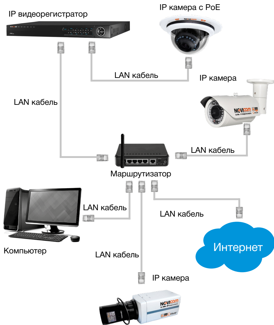
Рисунок 3.19 Подключение IP видеорегистратора с PoE.
