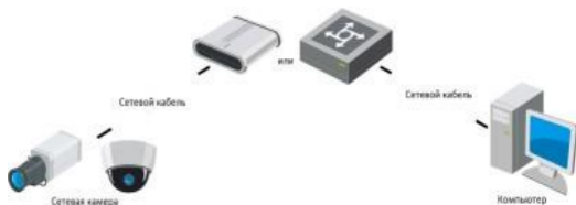
Рисунок 3-2 Подключение через коммутатор или роутер
