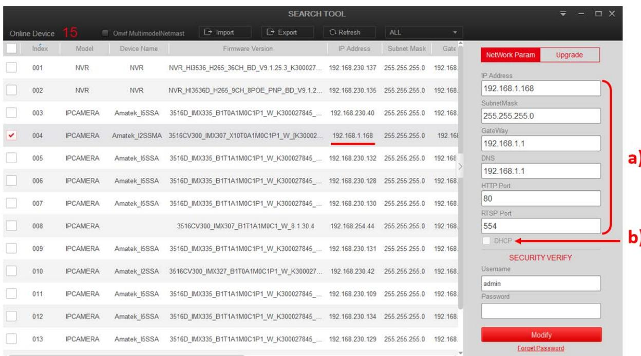
5. При первом включении камера имеет IP адрес по умолчанию. В данном случае это 192.168.1.168. Его необходимо изменить. Сделать это можно двумя способами:
