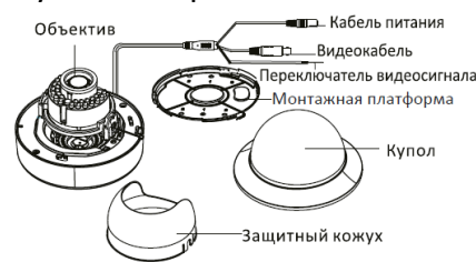
Рисунок 1-13 Купольная камера II типа
