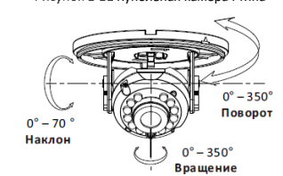
Рисунок 1-12 Настройка угла наблюдения камеры
