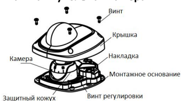
Рисунок 1-23 Настройка угла наблюдения камеры
