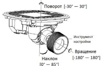
Рисунок 1-25 Настройка угла наблюдения камеры
