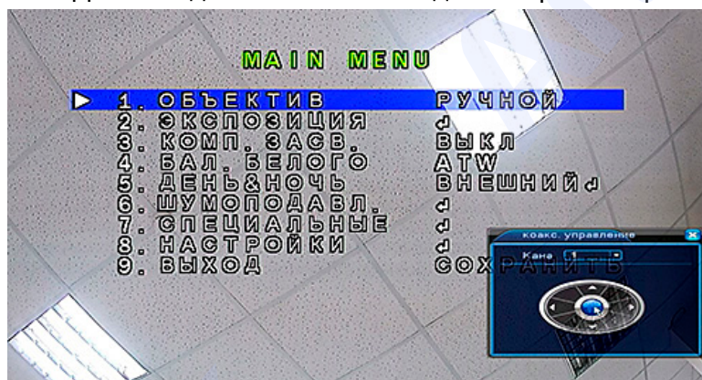
Рис. 3.16 Управление по коаксиалу
