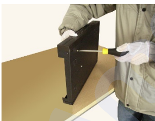
④ затяните шурупы диска
