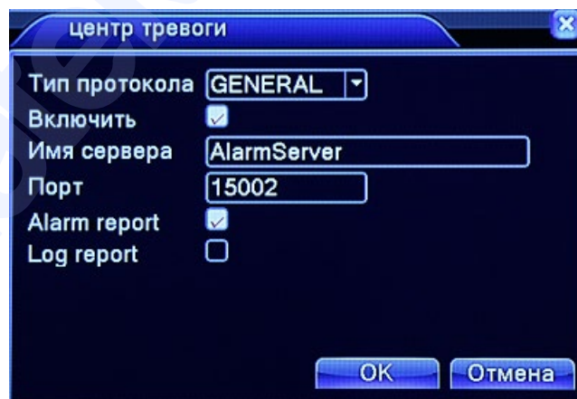
Рис. 4.11 Установки Центра тревоги
