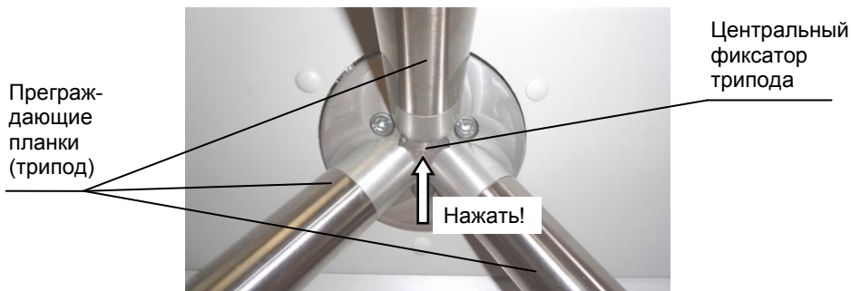
Рис.4 Место расположения центрального фиксатора трипода
