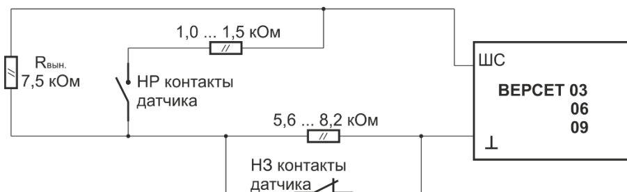
Рис.6. Схема включения технологических датчиков в ШСТ.
