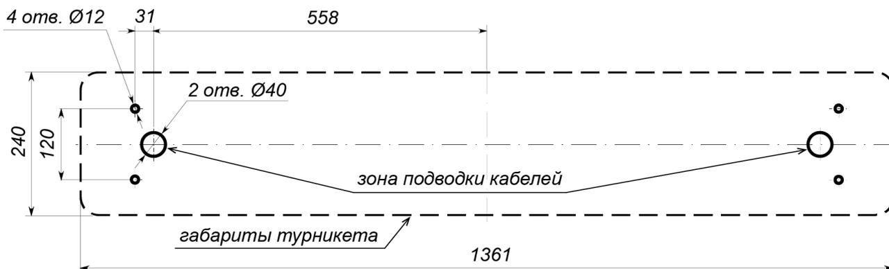
**Рисунок 16. Схема разметки для установки стойки турникета**
