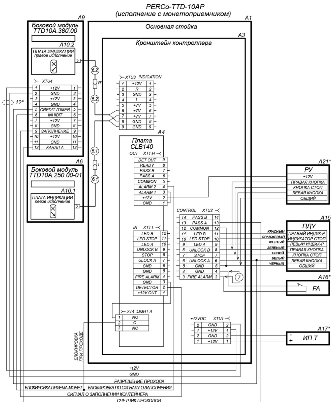
Рисунок 22. Пример схемы соединений турникета и доп. оборудования для модификаций с монетоприемником PERCo-TTD-10APR, PERCo-TTD-10APE<sup>1</sup>
