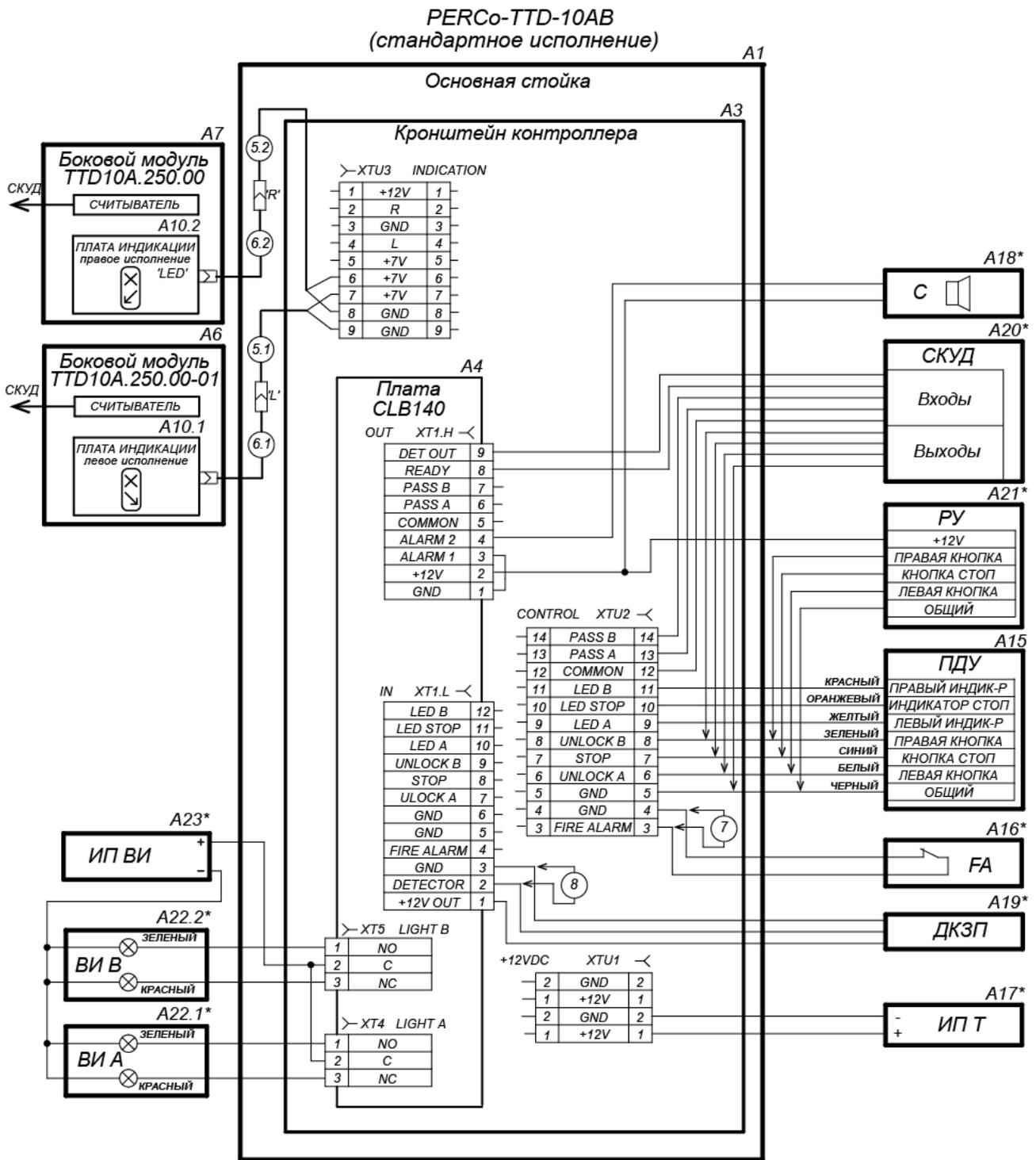
Рисунок 20. Схема соединений турникета и дополнительного оборудования для стандартной модификации PERCo-TTD-10AB<sup>1</sup>
