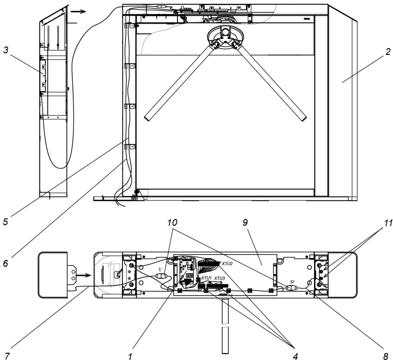
**Рисунок 15. Схема прокладки кабелей в стойке турникета**
