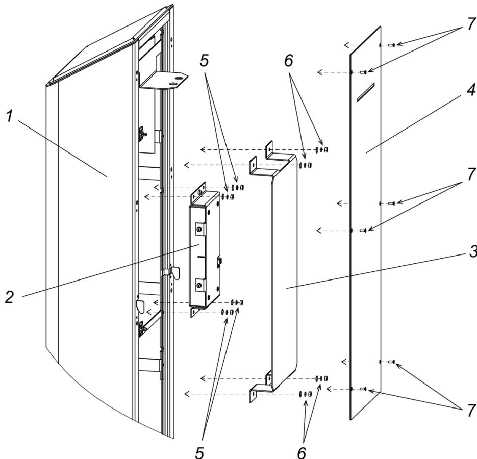
**Рисунок 17. Блок постоянной индикации стандартного бокового модуля**
