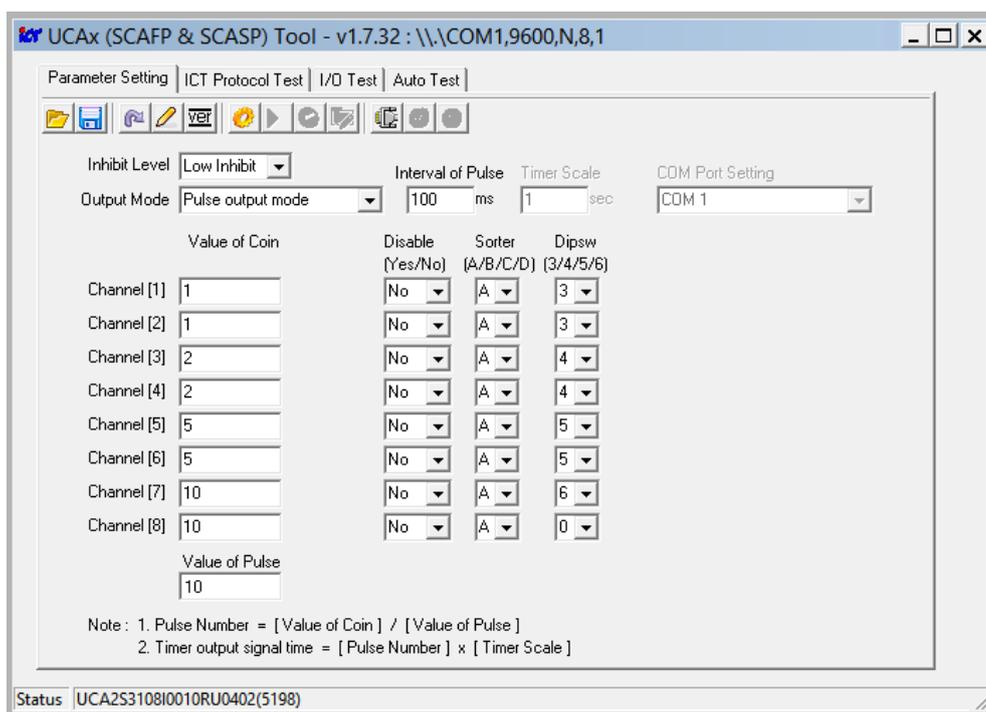
Рисунок 33. Внешний вид окна программы с установленными настройками (приведен пример конфигурации на прием суммы 10 рублей)
