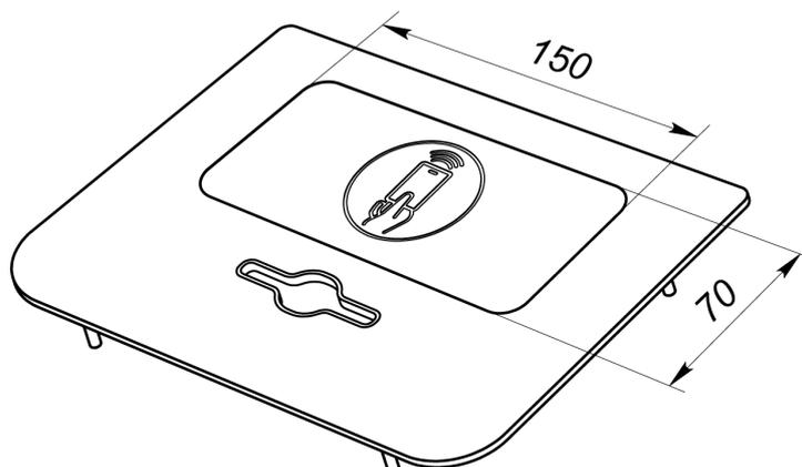
Рисунок 29. Внешний вид боковой крышки **PERCo-C-10RC**
