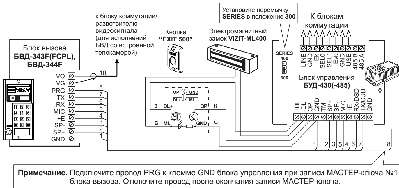
Рисунок 2 - Схема соединений блока вызова БВД-343F(FCPL), БВД-344F с блоком управления БУД-430(-485) , электромагнитным замком VIZIT-ML400 и кнопкой “EXIT 500”
