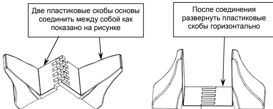
Рисунок 3 - Сборка пластиковых основ для вертикальной установки изделия.
