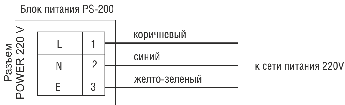
Рисунок 7.6.1 Схема подключения блока питания
