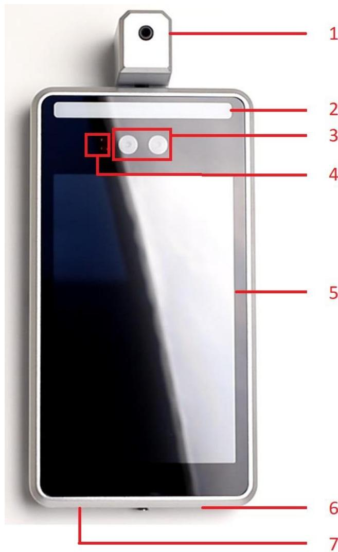
**1 - датчик измерения температуры:** термоэлемент, предназначенный для определения температуры человека при верификации.
