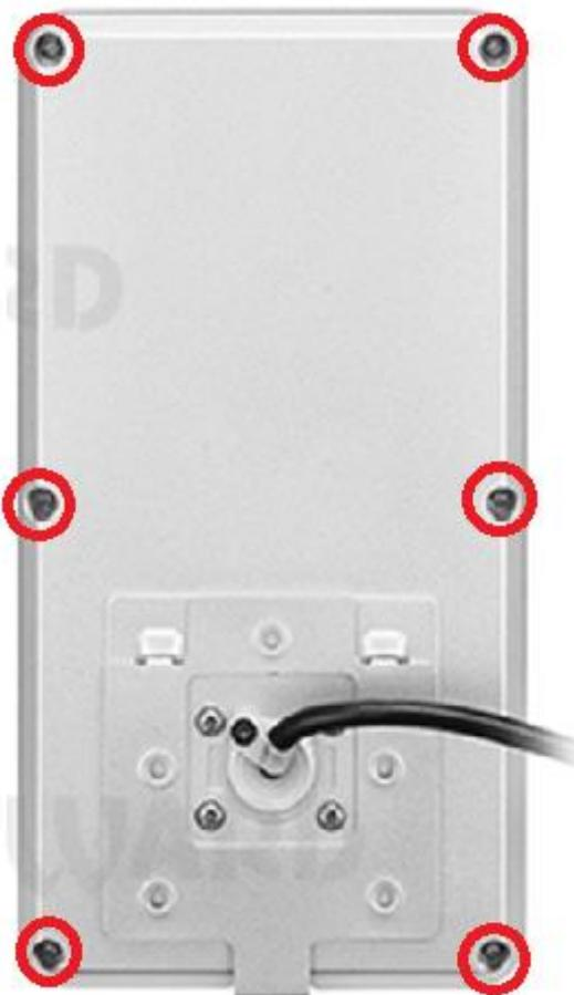
**Шаг 2:** снимите заднюю крышку терминала.
