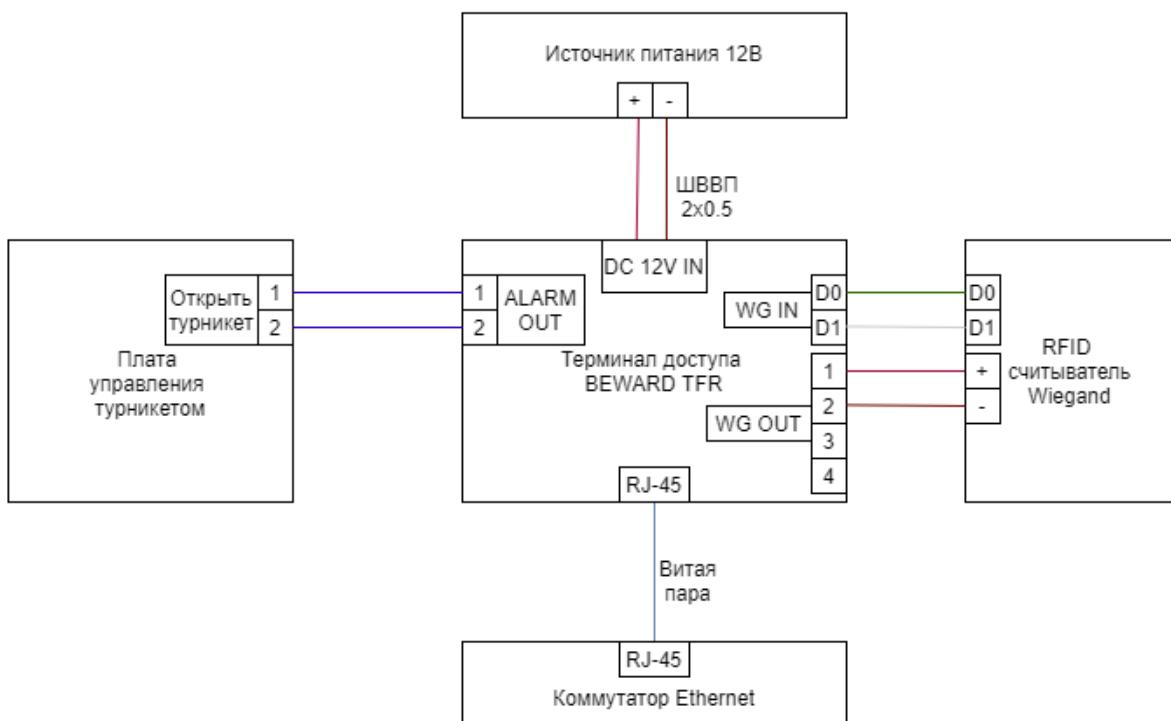
Если терминал доступа BEWARD выступает в роли считывателя на точке прохода, то при успешной идентификации сотрудника на терминале, от терминала на сторонний
