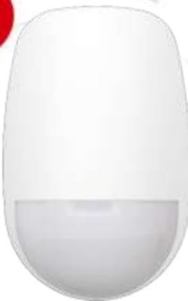
Внутренний извещатель DS-PDP15P-EG2-WE является беспроводным PIR-датчиком с двусторонней беспроводной связью, функцией обнаружения движения, защищенной от несанкционированного доступа, индикатором низкого заряда батареи и функцией контроля. Время работы от встроенной батареи достигает 5 лет. Извещатель выполняет мониторинг области в радиусе 15 м с фильтрацией ложных срабатываний на животных и детекцией человека.
